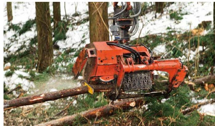
②枝払いと玉切りを専門に行うプロセッサ。材をつかむグラップル、枝払い用のカッター、材送り装置のフィードローラー、玉切り用のチェーンソーで構成される。③プロセッサはまず、グラップルで伐倒された木の根元をつかんでカッターで枝を除去した後、あらかじめ設定した長さでチェーンソーで玉切りする
